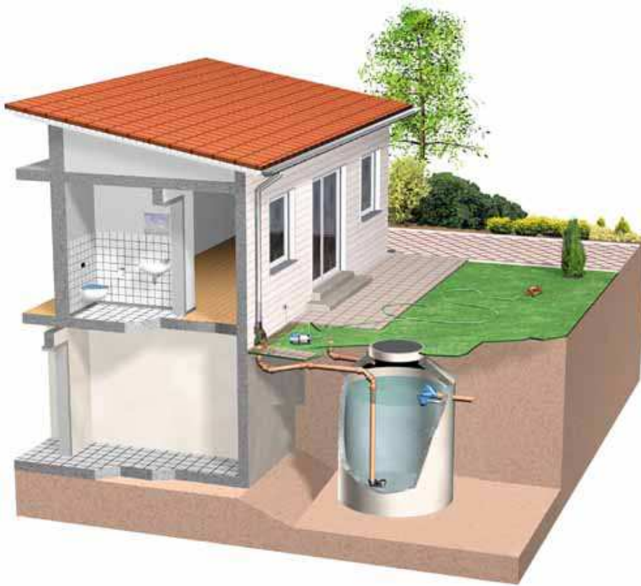
FIGURA 5: Instalação para reaproveitamento da água
